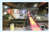
2023年6月,包钢股份BT620QL6低温止裂钢板成功研发生产。BT620QL6低温止裂钢板主要用于制造矿用车厢结构件及车架。包钢股份科研项目组整合优势资源开展技术攻关,找出影响焊接后热影响区冲
