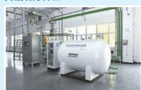
国家稀土功能材料创新中心研发的全国首台套固态储氢系统示范装置为工业用氢提供高效、可靠的氢气回收再利用提供"稀土方案"。国创中心设计并制造出具有优良热量管控能力的高密度氢气回
