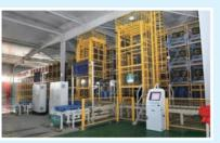
2023年5月15日,包钢集团首个四向车型智慧立体库——北方稀土检修服务分公司智慧立体仓库正式投入运行。智慧立体库占地面积2340平方米,设计储位2998个,载各8台四向穿梭车和2台大负载特是提升机,结合数据通信、采集物料、编码扫描以及仓储管理、智慧等法、人机界面优化等技术,可实现货物自动化存储,具备每天600吨货物的综合出入库能力,大幅提升北方稀土仓储作业效率,降低破损率,更好协同产销节奏。
